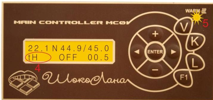
Рис.3. Передняя панель контроллера, включен нагрев.
