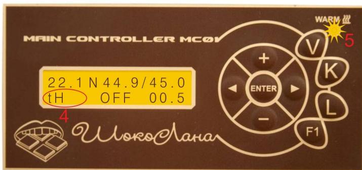
Рис.3. Передняя панель контроллера, включен нагрев.
